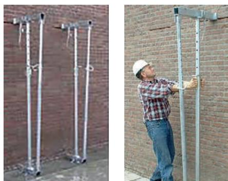
Le Stut Alone est un outil simple pour soutenir la maçonnerie lors de la construction de nouvelles ouvertures de fenêtres ou de portes et de passages. Le profil en acier du Stut Alone s'insère dans un joint découpé dans la maçonnerie. La distance entre la façade et l'étai est de 250 mm.
